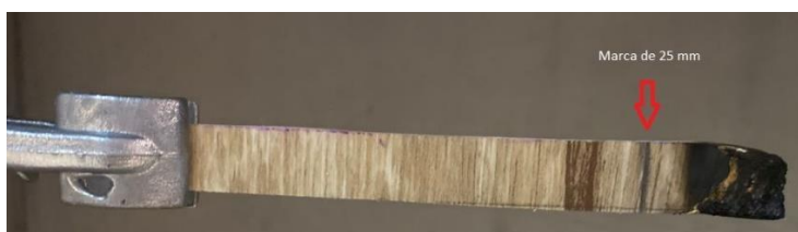
Figura 2- Amostra 2 (Troyes), exemplificando a queima horizontal das amostras.
